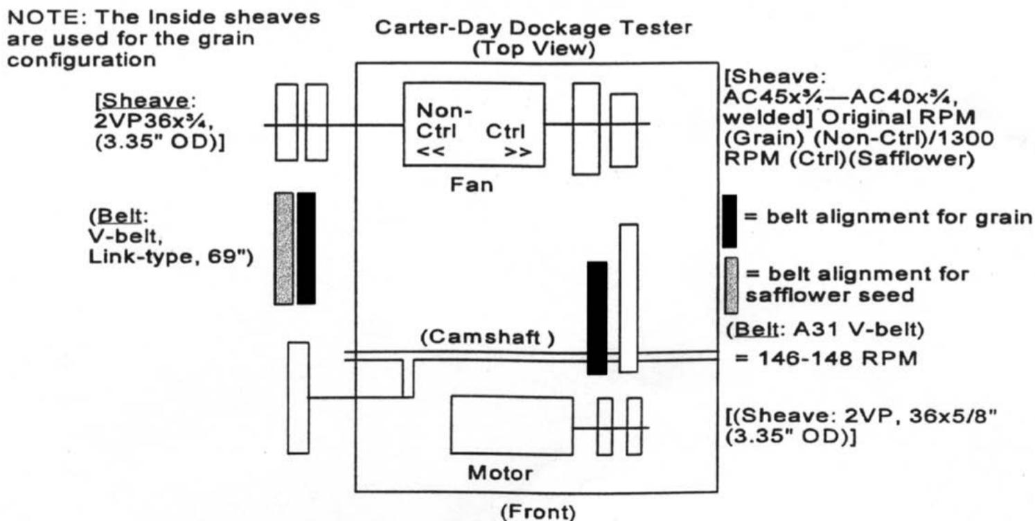
Fig. 3 STEP-BY-STEP PROCEDURE
